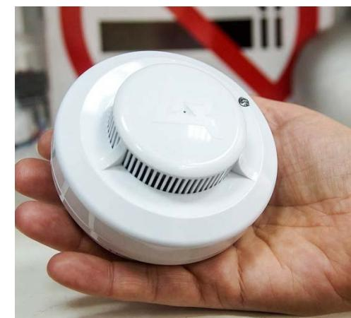
Если говорить простым языком – это прибор, работающий автономно от батареек и подающий громкий звуковой сигнал при появлении дыма в помещении. Принцип работы прибора, порядок его установки и подготовки к работе, а также технического обслуживания и проверки технического состояния приводятся в паспорте извещателя.
